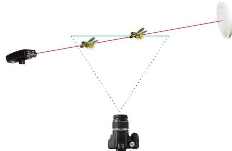
Abbildung 25: Schärfeebene schneidet den Lichtstrahl
