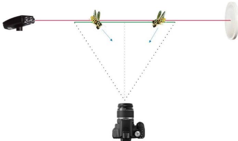
Abbildung 24: Schärfeebene parallel zum Lichtstrahl
