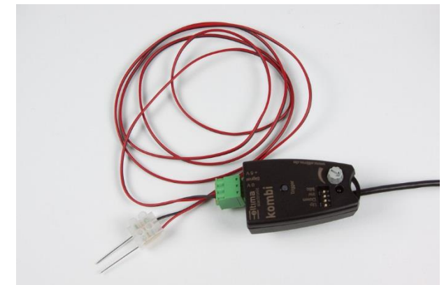
Abbildung 7: Elektroden zur Detektion von Wasser oder Feuchtigkeit
