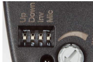
Abbildung 14: Schalterstellung für Sensoren mit Analogausgang
