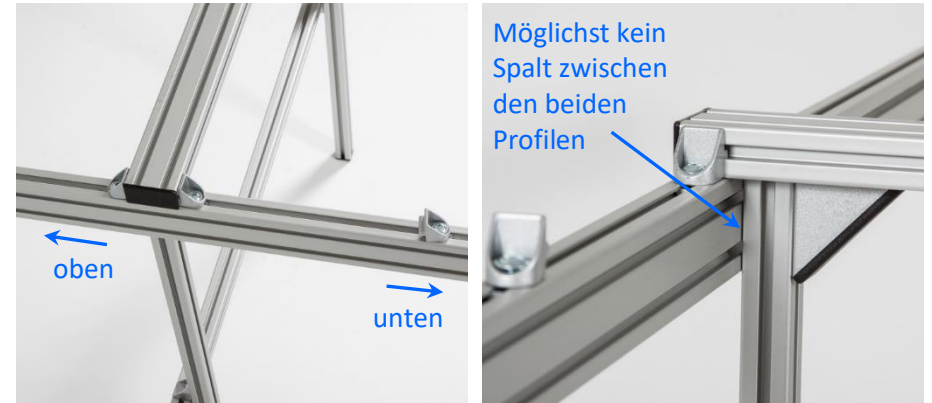
Abbildung 18: Details zum Einhängen des Tropfenspenderträgers
