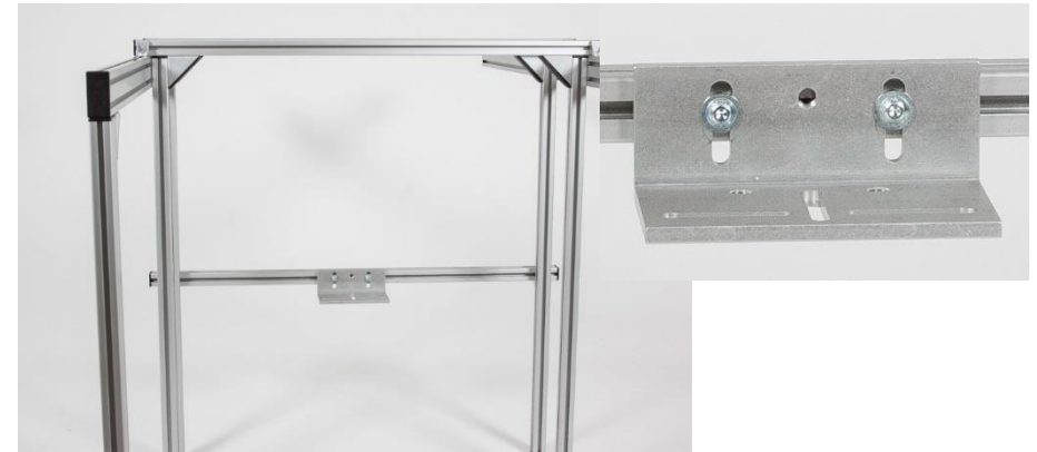
Abbildung 21: Montage des großen Zubehörwinkels
