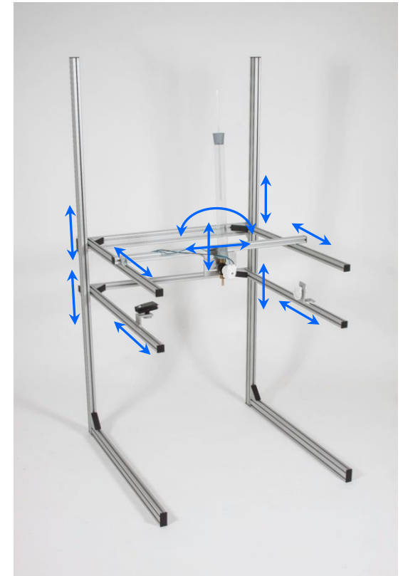
Abbildung 23: Einstellmöglichkeiten des Trägersystems
