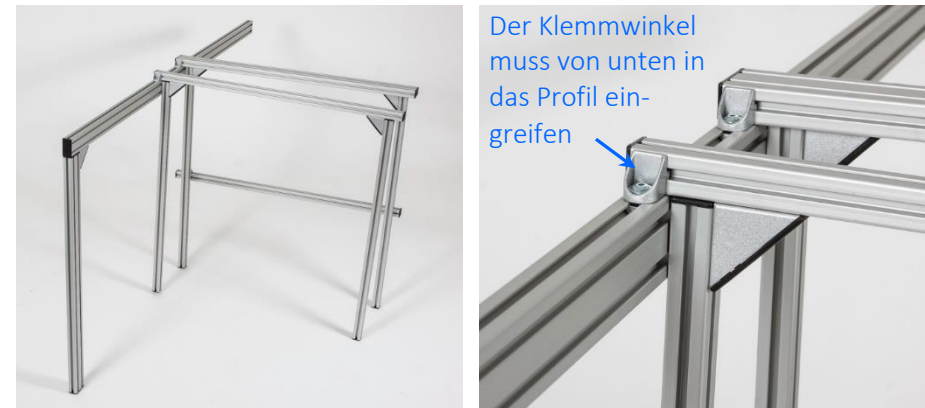
Abbildung 19: Einhängen des Lichtschrankenträgers
