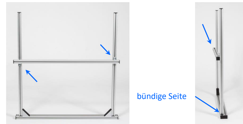
Abbildung 15: Befestigung des Querprofils
