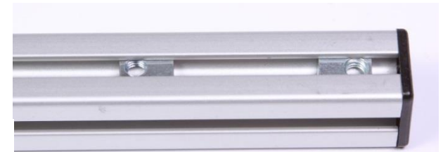
Abbildung 4: Einlegen der Nutensteine
