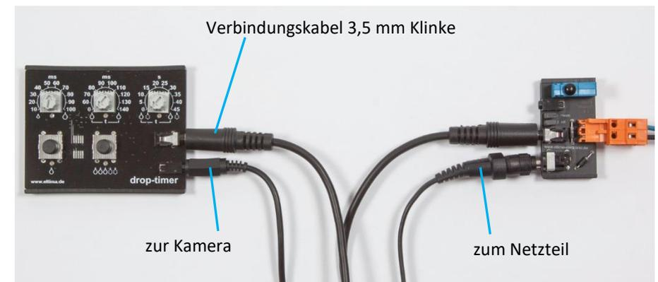
Abbildung 16: Anschluss an den drop-timer
