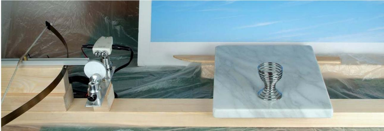
*Der Aufbau besteht aus einigen Holzleisten als Halterung, der Lichtschranke, einem Hintergrund und der Abschussvorrichtung nach Art einer Armbrust. Wichtig ist, dass am Ende der Schussbahn ein großes Kissen o. Ä. das Geschoss auffängt. Decken Sie das Umfeld weiträumig mit Folie ab und tragen Sie eine Schutzbrille.*
