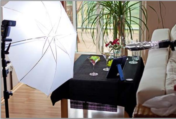
**Abbildung 3:** Licht-Setup für ein Fruchtcocktail-Foto: Gegenlicht durch Fenster, Durchlichtschirm von links, Spiegel gegenüber, zweiter Blitz mit Snoot für das hintere Glas, RF-getriggert via Yongnuo RF-602. In den Cocktailschalen befinden sich im Moment als ‚Lichtstatisten‘ ein paar Bonbons.
